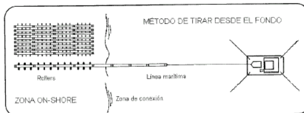
Imagen 64. Procedimiento de arrastre por fondo.
